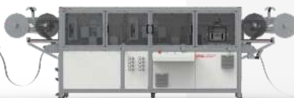
Ligne de production automatisée avec double lamineur Dimensions : L 13 780 × l 3 790 × H 2 120 mm
